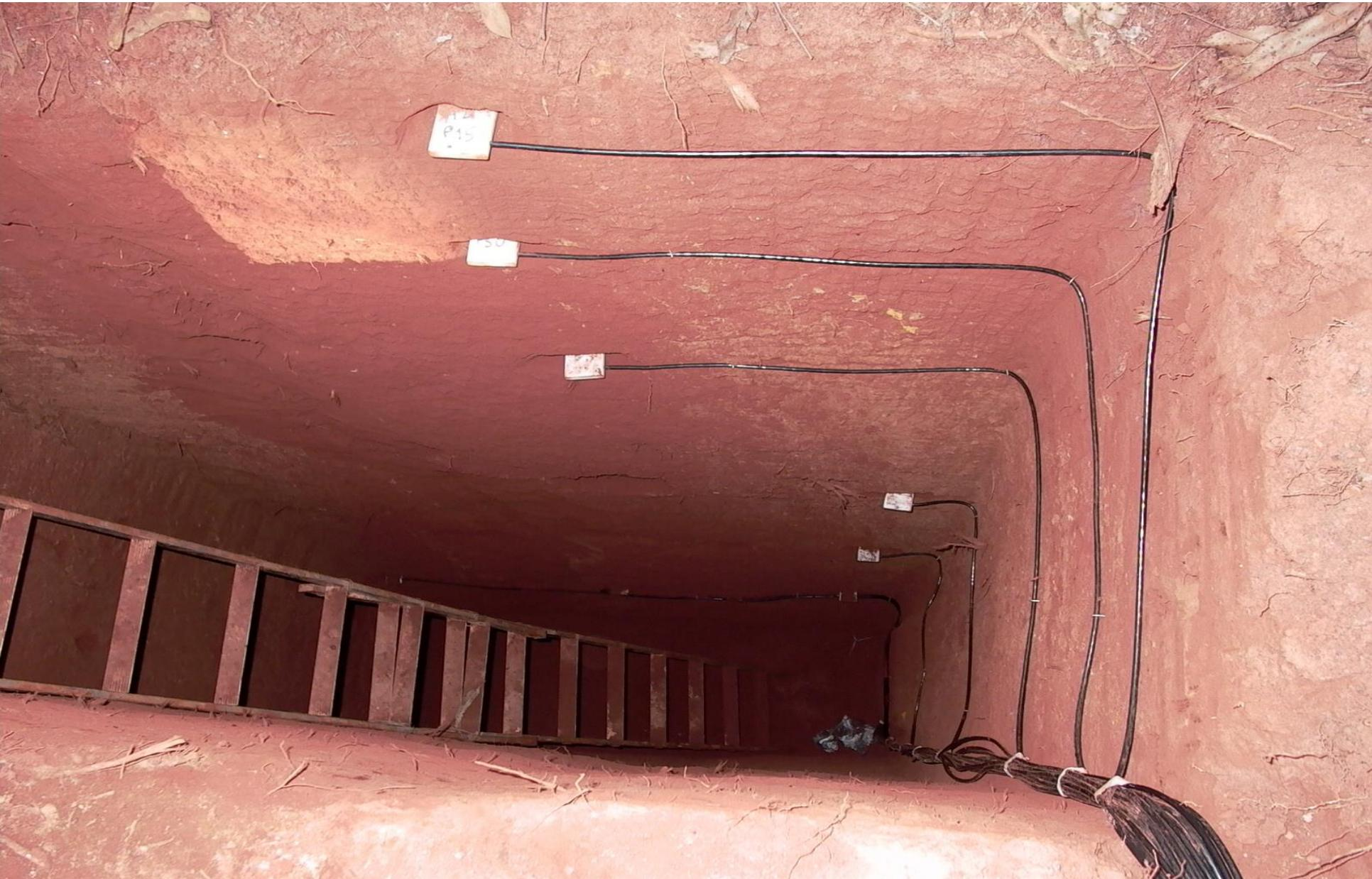
**Sensores de umidade do solo : 0.15, 0.50, 1, 2, 3, 4, 5, 6, 7, 8, 9, 10 m**
