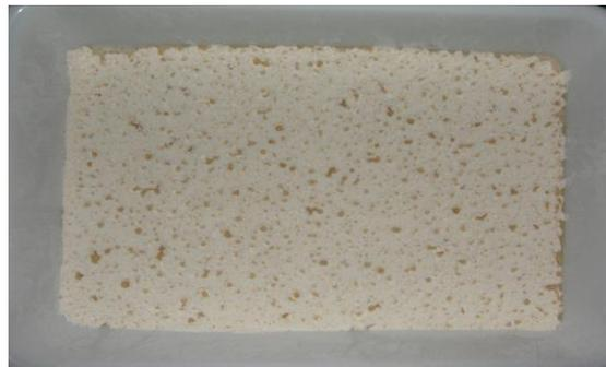
**Figura 1.** Bandeja de plástico preenchida com farinha de trigo para coleta de gotas de chuva para verificar o diâmetro da gota.
