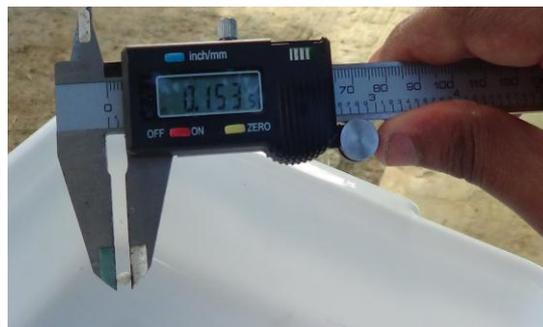
**Figura 2.** Uso de paquímetro digital para determinação do diâmetro das gotas de chuva.
