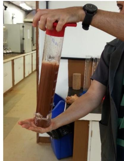
**Figura 2** – Procedimento realizado para misturar solo-calcário-água para avaliação da decantação/desagregação.
