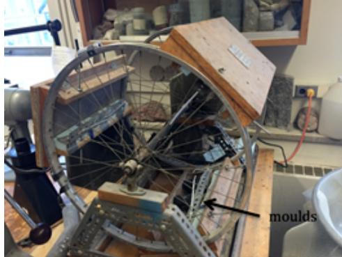
Figura 2: Roda giratória com os moldes fixados, simulando a “gravidade zero”.
