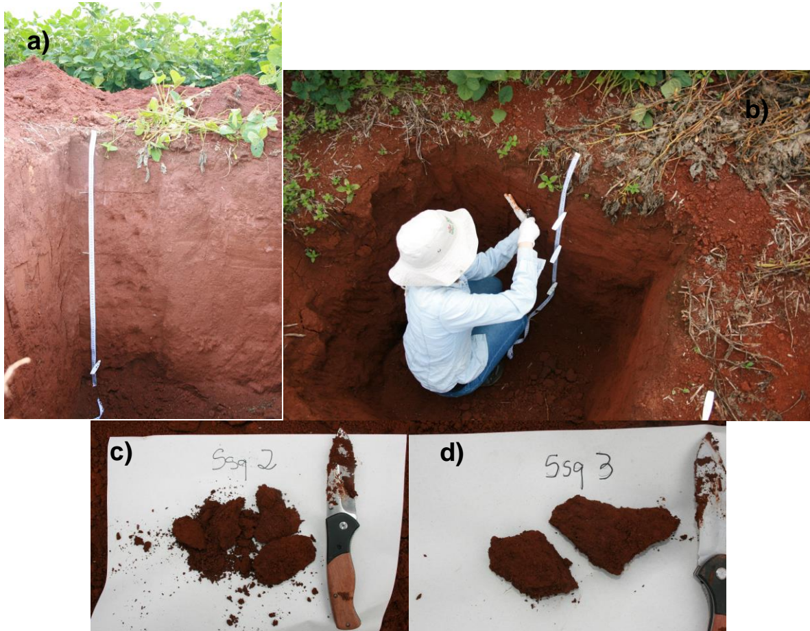
Figura 1 – a) Camadas marcadas após sua resistência ter sido identificada com o auxílio de uma faca; b) Agregados sendo retirados de cada camada para avaliação; c) Aparência de agregados com Qualidade estrutura Qes 2; d) Aparência de agregados com Qualidade estrutura Qes 3.
