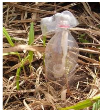
Figura 2 - Câmara coletora de amônia, instalada no campo.
