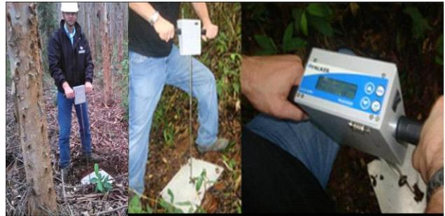
**Figura 1.** UP 54C226, Fazenda Santana. Ensaio de resistência do solo à penetração (RP), realizado com o penetroLOG – medidor eletrônico de compactação do solo.
