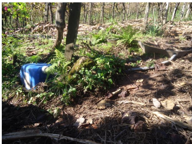
Figura 1 – Coletor de sedimentos + água instalado em área do parreiral no município de Pinto Bandeira, RS
