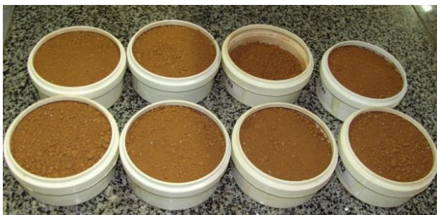
Figura 1: Representação das Câmaras de fluxo difusivo utilizadas na condução do experimento com doses e tempo de contato com fertilizantes fosfatados. Unipam, Patos de Minas, MG, 2015.
