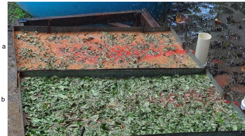
Figura 1. Aspecto da Lâmina de escoamento, na presença do corante, para determinação da Velocidade Superficial de escoamento
