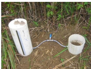
Figura 1. Infiltrômetro de anel utilizado na avaliação da infiltração da água no solo em uma sucessão de uso com mata, mandioca, cacau.
