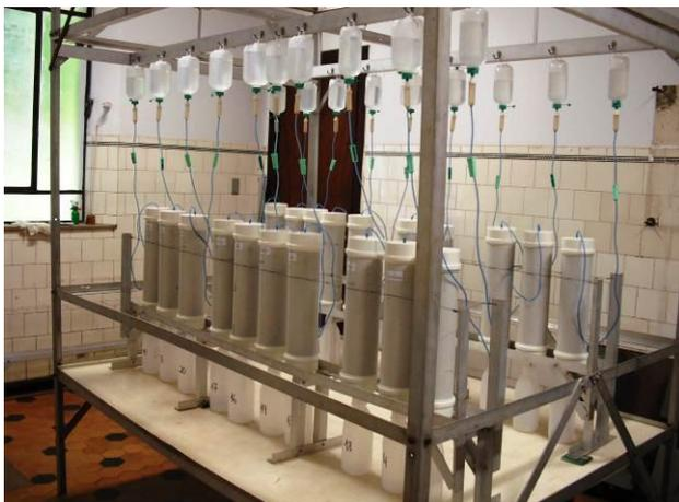
**Figura 1** - Ensaio de colunas de lixiviação no IAC, Campinas, SP. Fonte: ROSSINI, L.A (2015).
