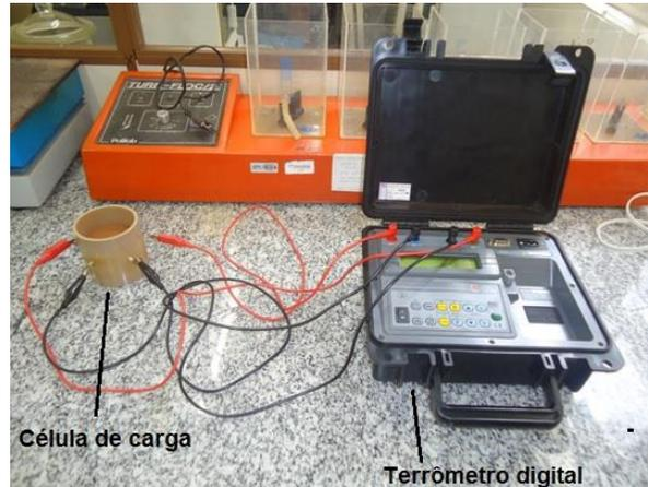
**Figura 1** – Célula de carga e terrômetro digital utilizados no experimento de bancada.
