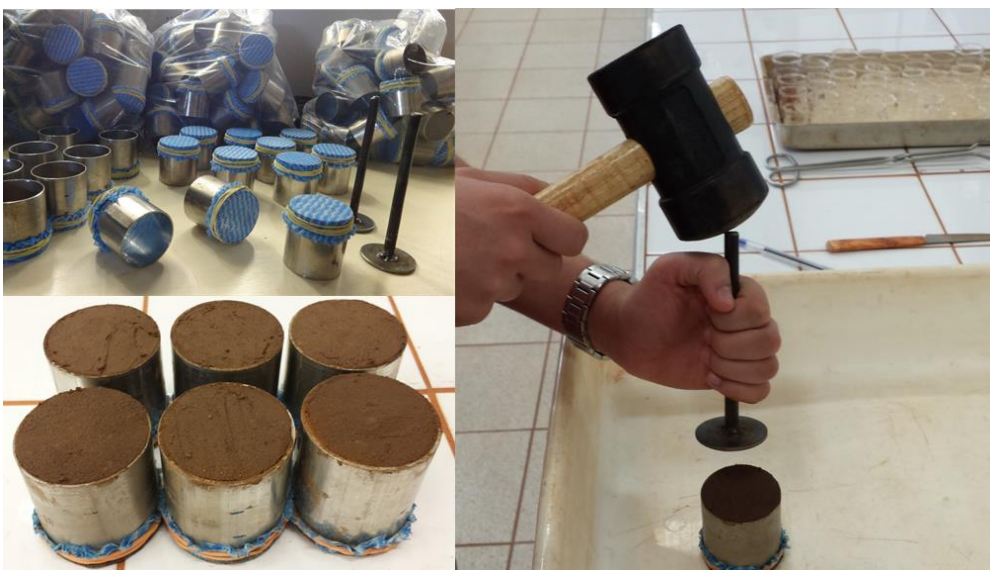
Figura 1. Imagens da construção dos cilindros ou corpos de prova para determinação do IHO.
