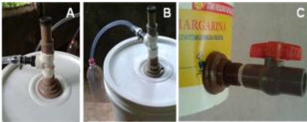
Figura 1. Confecção dos biodigestores. A. Sistema de adição de minerais, B. Sistema de dissipação de gases, C. Sistema de coleta de amostras. (Fonte: o autor)
