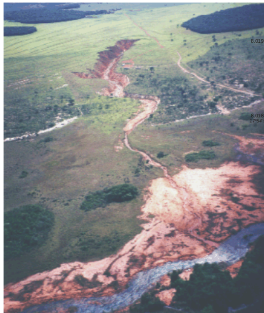
Vista aérea da erosão Chitolina, na Fazenda Chitolina. Observe-se a extensa área de assoreamento que soterrou a mata ciliar, os vários sulcos na área de pastagem e o traçado das curvas de nível cortadas pela erosão. Fonte: Acervo da Fundação EMAS (1998)
