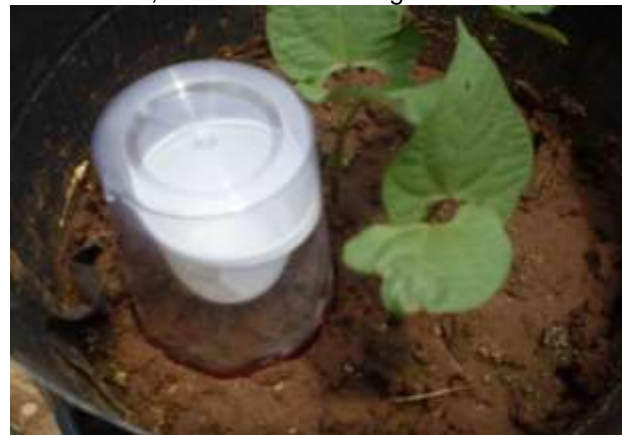
Figura 1. Mini respirômetro utilizado para determinação da respiração edáfica.
