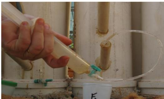
Figura 1: Extração da solução do solo das colunas.
