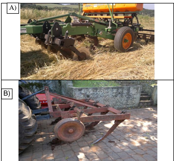
Figura 1 – A) Subsolador com disco de corte e rolo nivelador. B) Subsolador convencional.
