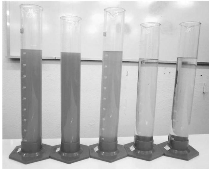
**Figura 1** - Dispersão do Latossolo Vermelho nas provetas após 24h de sedimentação. A concentração de NaOH da solução aumenta da esquerda para a direita com valores de 1, 10, 100, 200 e 400 mmol L<sup>-1</sup>.
