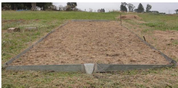
**Figura 2** É Unidade experimental, com  $38,5 \text{ m}^2$ .
