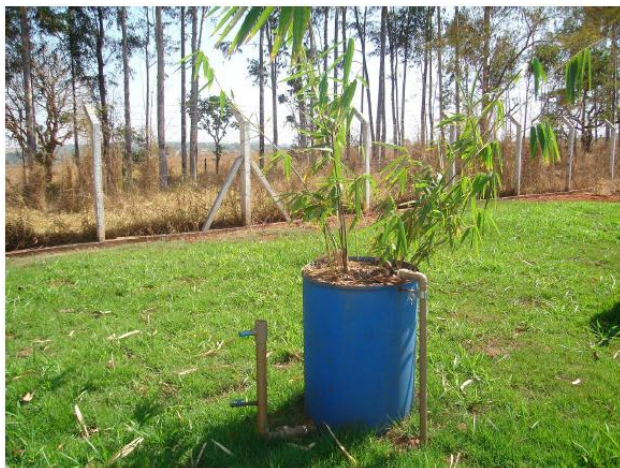
Figura 1 - Módulo individual de tratamento de esgoto industrial em solo vegetado com bambu.
