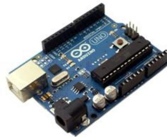
**Figura 1** - Plataforma Arduino modelo Uno, utilizada neste estudo.
