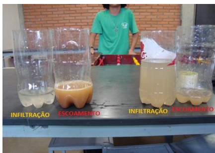
Figura 3: À esquerda, resultado do simulador de solo exposto. À direita, resultado simulador de cobertura vegetal. Fonte: Ramos, 2012.
