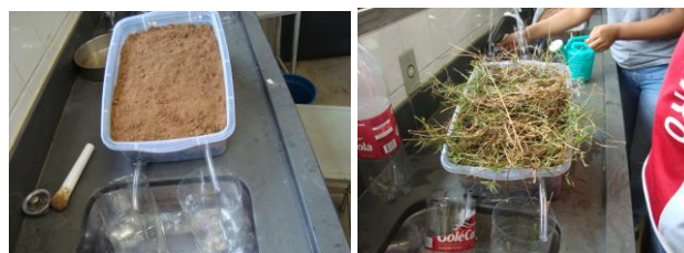
Figura 2: Simulador de solo exposto e de solo protegido. Fonte: Ramos, 2012.
