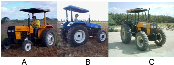
Figura 1 – Tratores utilizados para obtenção dos níveis de carga. A – Valtra 585; B – New Holland TT3840; C – Valtra 785 TDA
