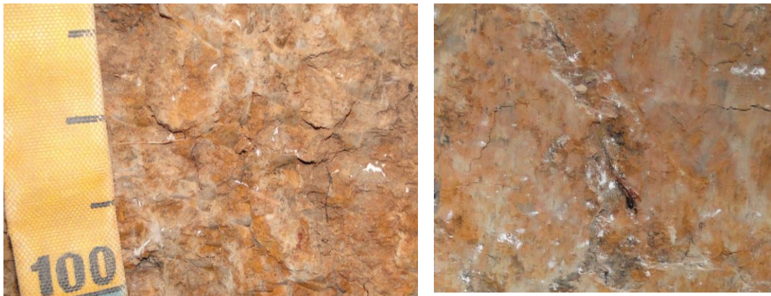
(a) (b) Figura 3. Precipitação de forma irregular de calcita entre agregados (a) e próximo a canais de raízes (b).
