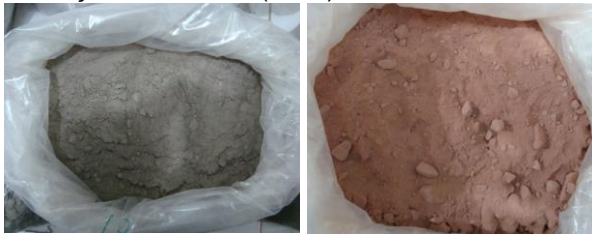
Figura 1. Preparo dos resíduos de perfuração de poços de petróleo (Poço 7-MGP98-D BA e Poço 7-SMC 50-D AL), respectivamente.
